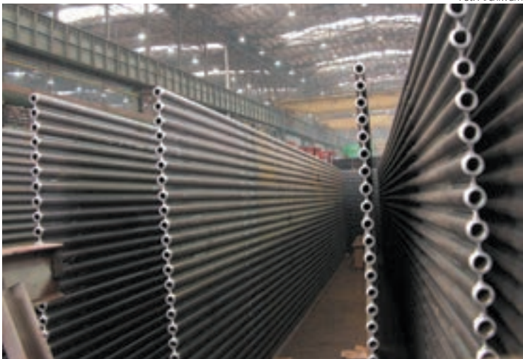
Ściany szczelne kotła czekające na załadunek w hali produkcyjnej RAFAKO
