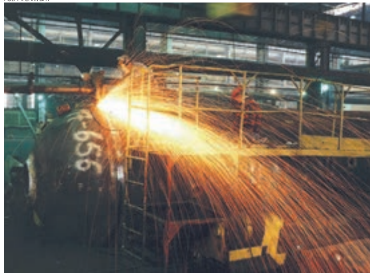
Walczak kotła podczas spawania na hali produkcyjnej RAFAKO
